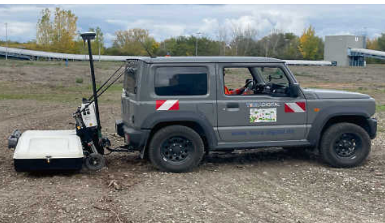
Mit so einem fahrzeuggestützten Bodenradar können alle metallischen und nichtmetallischen Leitungen und Rohre identifiziert werden. Foto: Terra Digital
